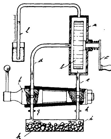
dass das Gehäuse a eines Ventilators b mittels zweier Röhren d, e und eines Mehrweghahnes f mit einem Absorptionsraum i in Verbindung steht, so dass der Ventilator durch entsprechende Stellung des Mehrweghahnes abwechselnd mit dem äußeren Raum oder mit dem Absorptionsmittel kommuniziert und
